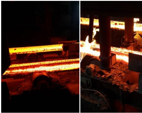
Şekil 2. Soğuma boyunca kütük üzerinde oluşan tufal tabakası
