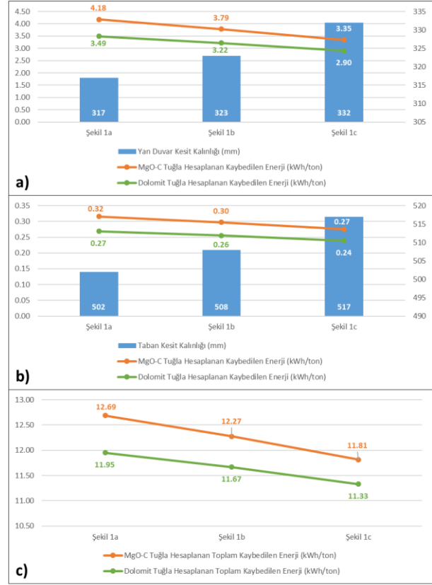
Şekil 3. Farklı tuğla ve farklı izolasyon konfigürasyonları için hesaplanan a) yan duvar, b) taban ve c) toplam enerji kayıpları
