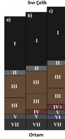
Şekil 2. a) Standart izolasyon, b) ilave katmanlı izolasyon ve c) ilave iki katmanlı izolasyon tiplerindeki pota taban katmanları
